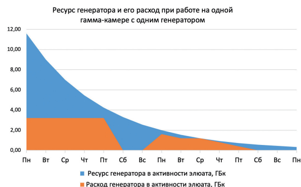
Рис. 3. Ресурс генератора, в активности (ГБк) получаемого элюата, по дням срока эксплуатации и его расход с учетом технологических возможностей при работе на одной гамма-камере.
