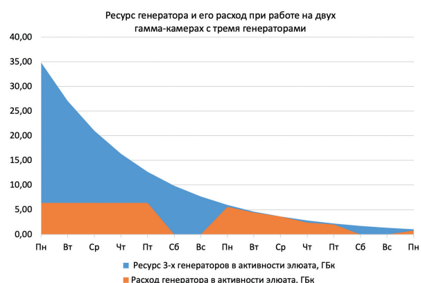
Рис. 5. Ресурс генератора и его расход при выполнении ОСГ на двух гамма-камерах и одновременной поставке трех генераторов.
